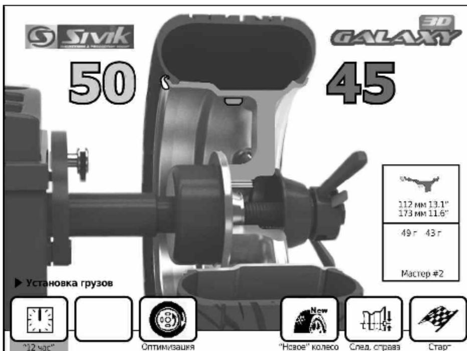
Рисунок 6.5 – Экран установки грузов
