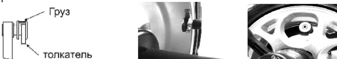
Рисунок 7.9 – Установка груза линейкой
