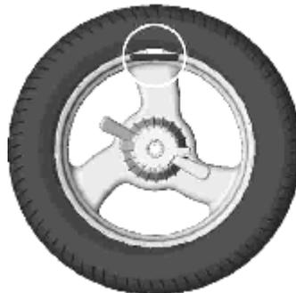
Рисунок 7.5 – Груз установлен в положение «12 часов»
