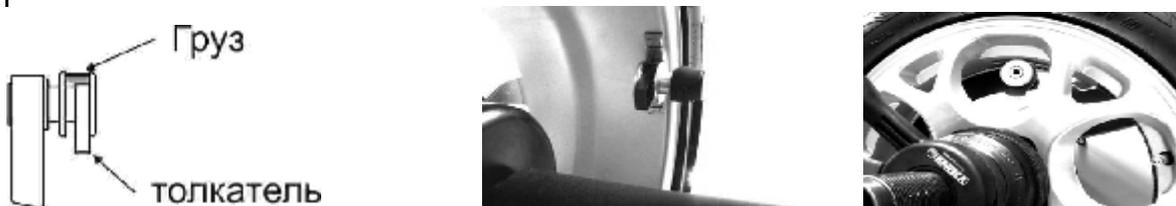
Рисунок 6.8 – Установка груза линейкой
