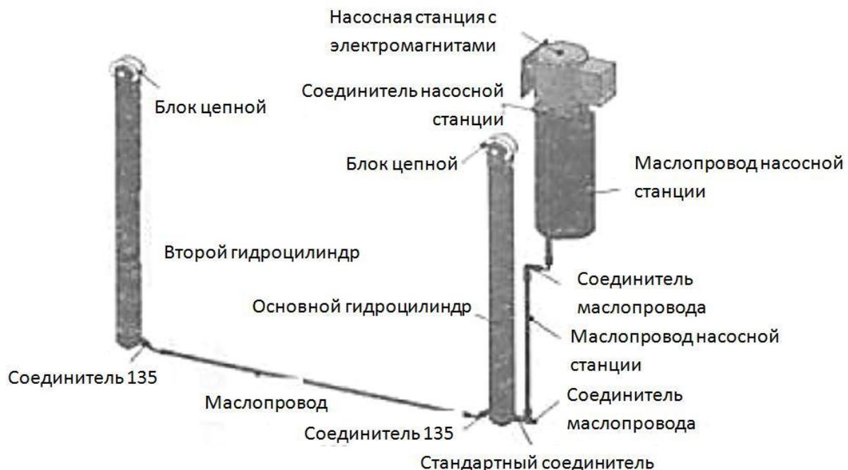
**Схема гидравлических подключений двухстоечного подъемника TS-5**
